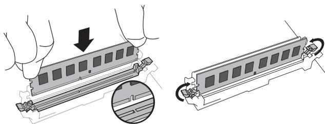
用力(甚至加压)将DIMM推进插槽,直至夹子卡入到位。切勿给夹子任何协助。
