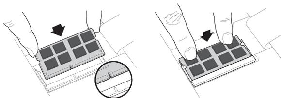
以45度角方向将SODIMM平稳推入,然后下压,直到卡扣扣紧为止。当它完全固定在插槽中时,露出的金色针脚长度不超过1.5毫米。
